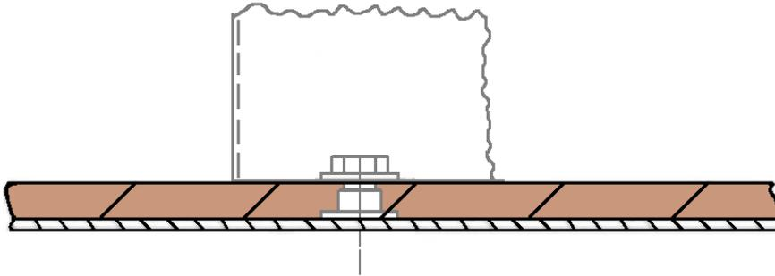
1. Markieren Sie die vorhandenen Löcher des Montageprofils auf dem 12 mm starken Holzboden unter dem BEKS-Schubkastensystem.
